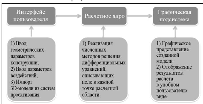
Рис. 13. Структура подсистемы трехмерного электромагнитного моделирования АСОНИКА-ЭМС
