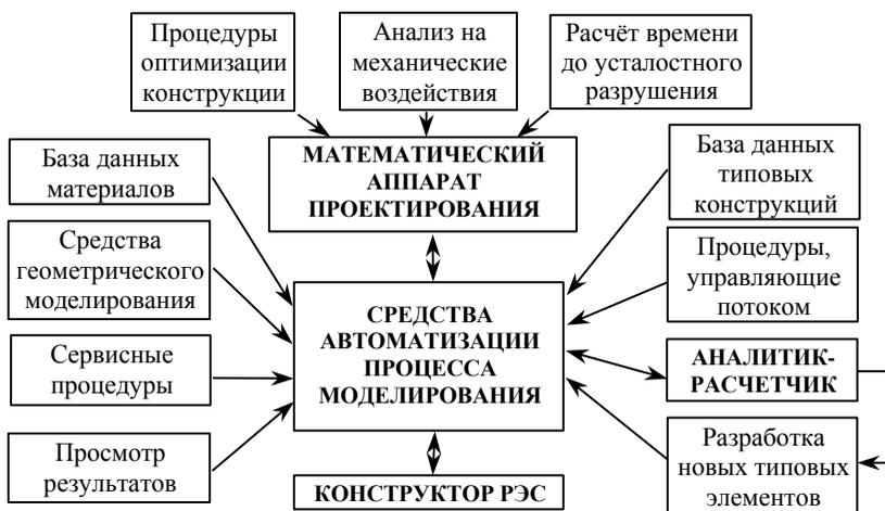
**Рис. 17.** Предлагаемая схема процесса моделирования конструкций РЭС
