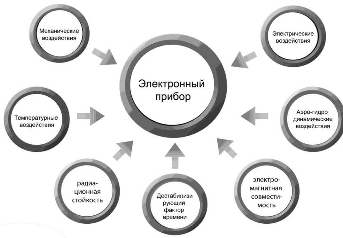
Рис. 1. Дестабилизирующие факторы при комплексном моделировании РЭА. Модели электромагнитных и радиационных воздействий планируется внедрить в 2011 г
