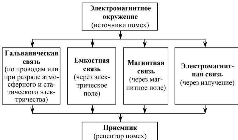
Рис. 2. Виды механизмов связи источников и приемников помех
